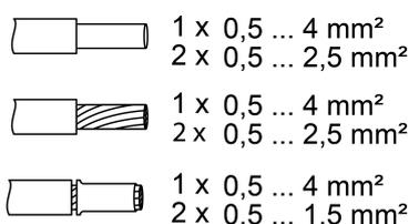
Imagem 4: Possibilidade de fixação de seções transversais
