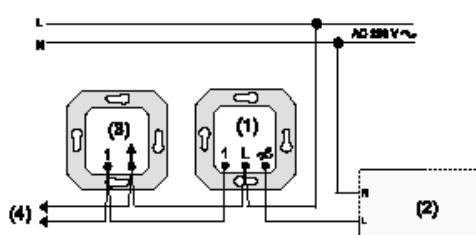
Lorsque l'insert de variateur de lumière BT a atteint sa pleine capacité, il est possible de brancher jusqu'à 10 unités additionnelles de puissance. Utiliser des unités additionnelles de puissance BT (appareil encastré ou de appareil de montage en série).
