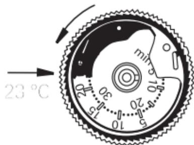
4. Comment régler la bague de réglage bleue sur la limite inférieure de température (ici 8 °C):
