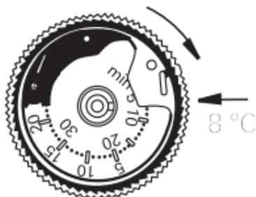
5. Enficher le bouton de réglage: ce faisant, l'aiguille doit être environ au centre de la nouvelle plage de réglage (voir point 1).
