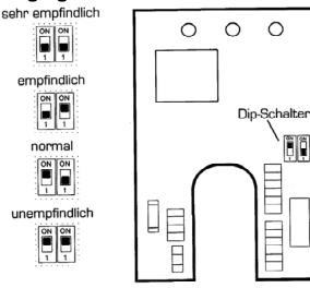
La sensibilité du capteur de pluie peut être réglée à l'aide d'un commutateur DIL bipolaire dans le bloc d'alimentation du capteur de pluie.
