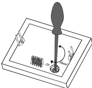
3. Kople apparatet til busstilkopleren igjen. IR-lageret slettes. Som bekreftelse blinker IR-vinduet oransje.
