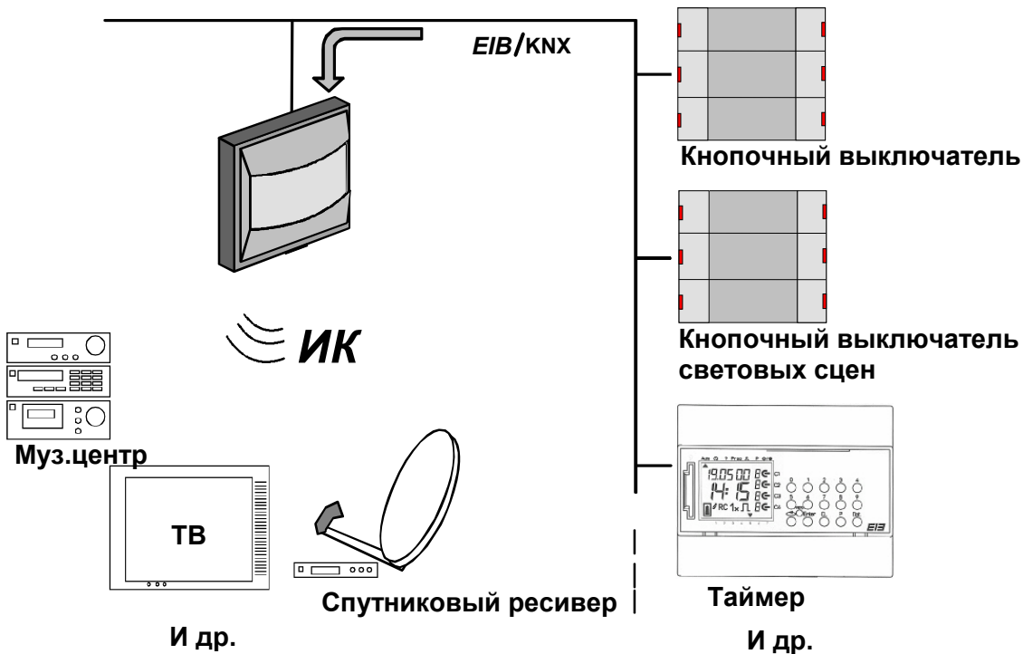
Рис. 4: Управление ИК компонентами с помощью датчиков EIB/KNX
