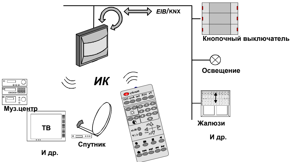
Рис. 10: Вызов различных ИК сигналов, запрограммированных в преобразователе ИК-Instabus, с помощью пульта ИК дистанционного управления
