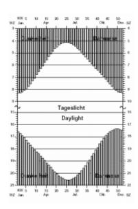
Si l'on veut que le volets roulant remonte toujours au lever du soleil et qu'il descende à la tombée de la nuit, les heures de déclenchement programmées pour la marche automatique doivent être adaptées continuellement aux changements du calendrier astronomique (voir Fig.).
