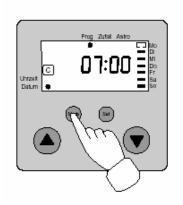
La touche **MODE** permet de désélectionner ou de sélectionner le jour de la semaine. Lorsque le jour est sélectionné pour un déclenchement, une barre apparaît à l'intérieur du cadre. Un cadre vide indique que le déclenchement n'est pas effectué ce jour de la semaine.
