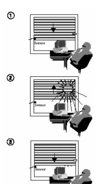
La fonction protection antisolaire se déclenche environ 2 minutes après que la valeur de luminosité programmée a été dépassée, le volets roulant se met à descendre. Cette temporisation (hystérèse) d'environ 2 minutes est nécessaire pour compenser les courtes variations de luminosité, Le volets roulant/store ne descend et ne monte pas à chaque fois qu'apparaît une différence de luminosité.
