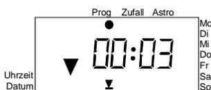
1. Confirme su selección mediante un breve accionamiento de la tecla [Set]. El relé para el sentido de subida se cierra, de modo que la persiana sube automáticamente en un intervalo de movimiento de dos minutos. Cuando la persiana ha alcanzado la posición final superior, el proceso se puede interrumpir, mediante una pulsación antes del fin del movimiento.
