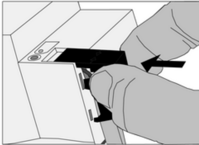
Рисунок 6: Установка защитной крышки
