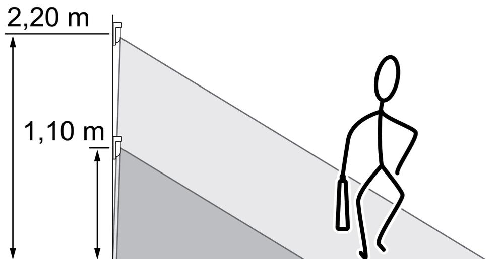
Figure 8: Champ de détection et hauteur de montage
