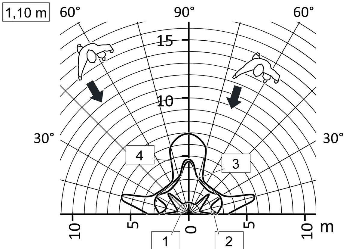
Figure 12: Portée en cas de sens de mouvement radial, hauteur de montage 1,10 m
