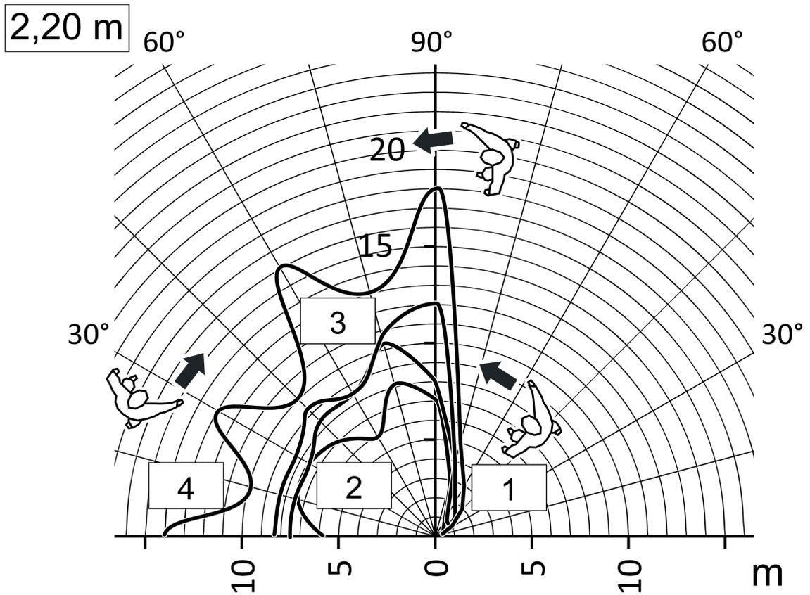
Figure 13: Portée en cas de sens de mouvement tangentiel, hauteur de montage 2,20 m, un seul capteur activé
