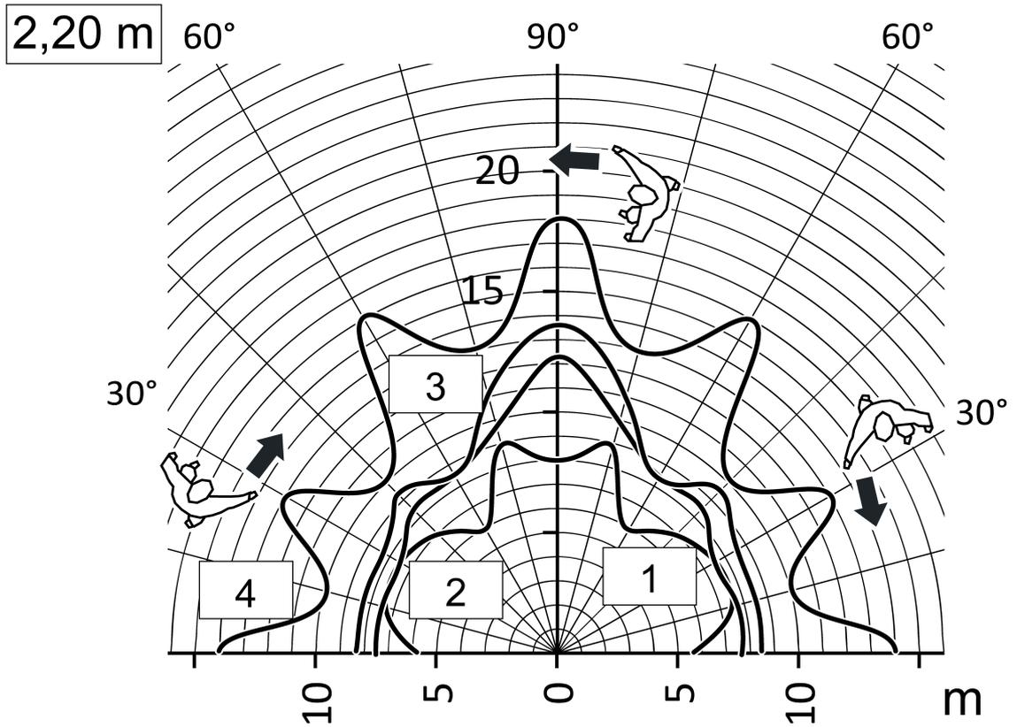
Figure 9: Portée en cas de sens de mouvement tangentiel, hauteur de montage 2,20 m
