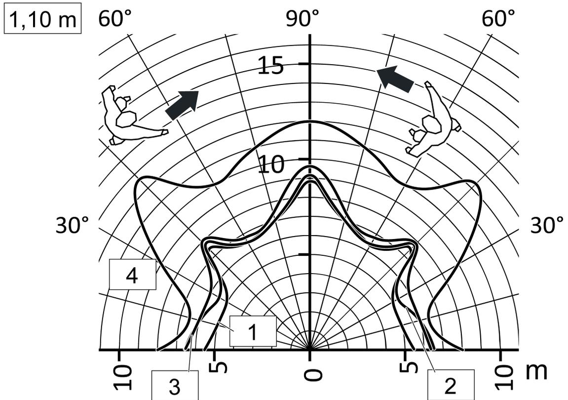
Figure 11: Portée en cas de sens de mouvement tangentiel, hauteur de montage 1,10 m
