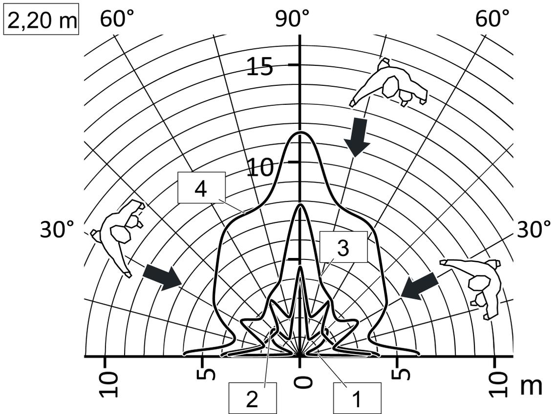
Figure 10: Portée en cas de sens de mouvement radial, hauteur de montage 2,20 m
