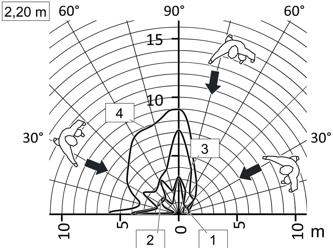
Figure 14: Portée en cas de sens de mouvement radial, hauteur de montage 2,20 m, un seul capteur activé
