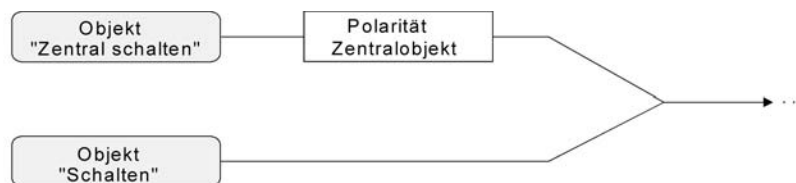
Bild 10: Funktionsschaltbild "Zentral Schalten"
