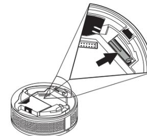
2. Drücken Sie kurz die Prog.-Taste des Funk-Moduls bis die LED blinkt. Der Testmodus ist gestartet.
