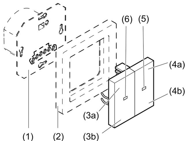
Imagen 1: Dispositivo de mando de 2 elementos
