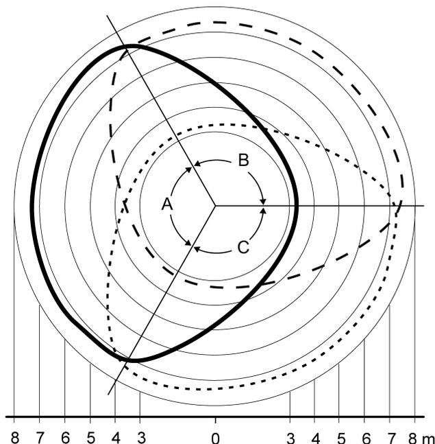
Figura 3: Campo di rilevamento: aree A, B e C, altezza di montaggio 2,20 m
