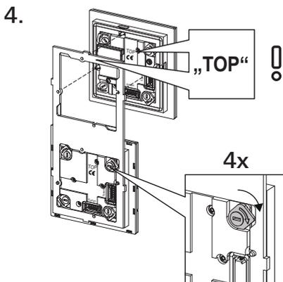
Inserire i moduli nel portamoduli (osservare l'indicazione TOP) e bloccarli in posizione. Per informazioni dettagliate sui moduli, vedere le istruzioni per l'uso dei singoli moduli.
