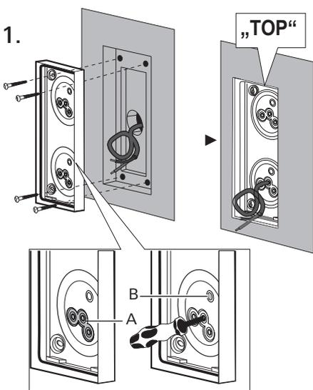
Selezionare un'apertura (A) per il passaggio del cavo e forarla con un oggetto rotondo (non con incisioni a croce). Non utilizzare mai la membrana (B) per il passaggio del cavo! Inserire completamente il cavo di collegamento nell'apertura e montare la scatola.
