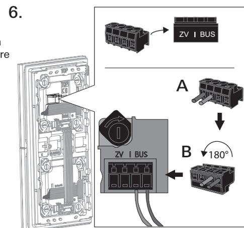
Tagliare il cavo di collegamento per adeguarne la lunghezza e collegarlo al morsetto (A). Ruotare il morsetto di 180° (B) e inserirlo nel collegamento del modulo vocale o modulo citofono esterno.
