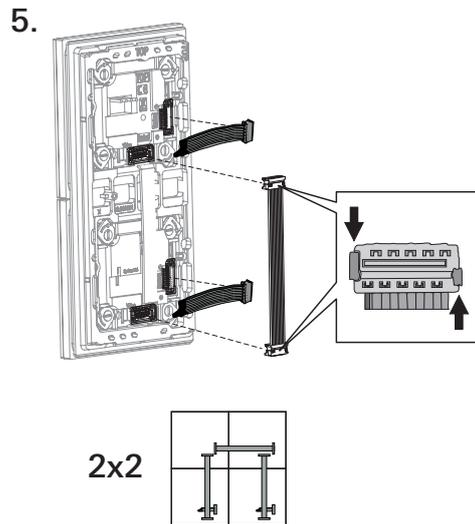
Collegare prima le resistenze terminali e poi il cavo di sistema. Collegare sempre una resistenza terminale sul primo e sull'ultimo modulo del cavo di sistema. Osservare la codifica dei connettori!
