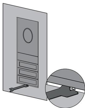
Stringere leggermente la vite di bloccaggio della scatola con la chiave di bloccaggio in dotazione (0,6 Nm).
