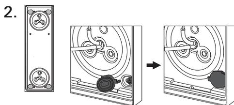
Premere saldamente il cappuccio di copertura della vite di collegamento al muro nell'incavo e controllare che sia posizionato correttamente.
