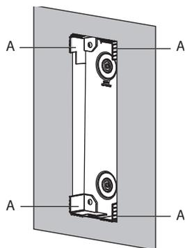
3. Belast de lijmverbinding niet gedurende 15 minuten. De eindsterkte van de lijmverbinding wordt na 72 uur bereikt.
