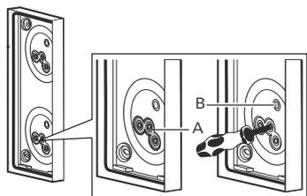
7. Steek de bevestigingsschroeven van de montagehoeken door de openingen van de behuizing. Als de frontplaat dikker is dan 1 mm: voor de hoogtecompensatie van de frontplaat, de onderlegringen op de bevestigingsschroeven schuiven en met een O-ring zekeren.
