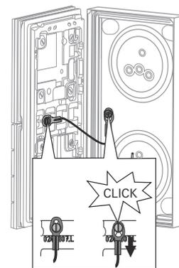
12. De schroef voor het vergrendeling van de behuizing met de vergrendelsleutel iets vastdraaien (0,6 Nm). De ingrijphoek bedraagt 90°.
