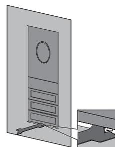
13. Stel met de vergrendelsleutel de positioneringsschroeven (C) van de inbouwdoos zo in dat de spleet tussen modules en frontplaat symmetrisch is. Vervolgens alle positioneringsschroeven vastdraaien.
