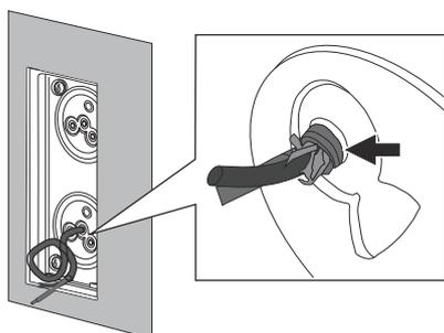
De aansluitkabel inkorten en met de steekklem verbinden (A). De steekklem 180° draaien (B) en aansluiten op de spraak- of deurstationmodule.
