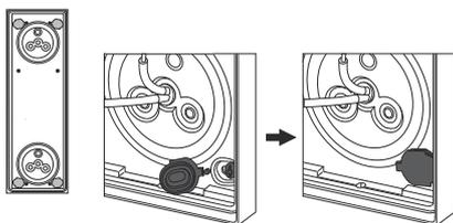
17. Eerst de afsluitweerstand en dan de systeemkabel aansluiten op de functiedrager met de modules. Altijd een afsluitweerstand op de eerste en laatste module van de systeemkabel steken. Stekker codering in acht nemen!
